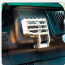
Składane podnóżki zwiększające ilość miejsca dla nóg
