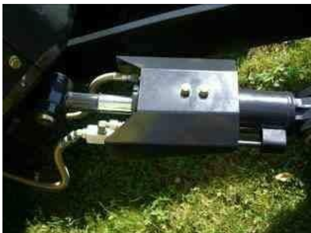
Zawór zabezpieczający na cylindrze lemiesz
