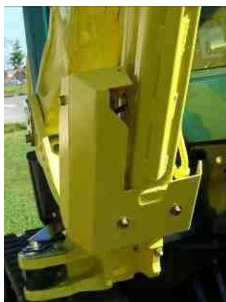
Zawór zabezpieczający na cylindrze bomu.
